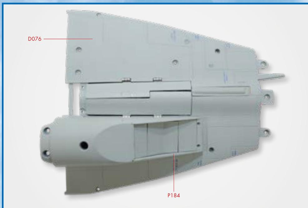
**5** Закрепите воздухозаборник тремя винтами КР в местах, указанных на снимке. При закручивании винтов не прилагайте особых усилий, чтобы избежать повреждения деталей и винтов.
